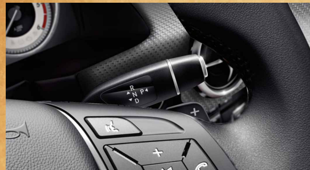
Cần chuyển số trên vô lăng và lẫy lên số/ xuống số kiểu thể thao Transmission control with the DIRECT Gearshift lever on the steering wheel
