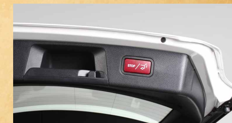
Đóng cửa sau bằng nút bấm EASY-PACK tailgate with electrical closing function
